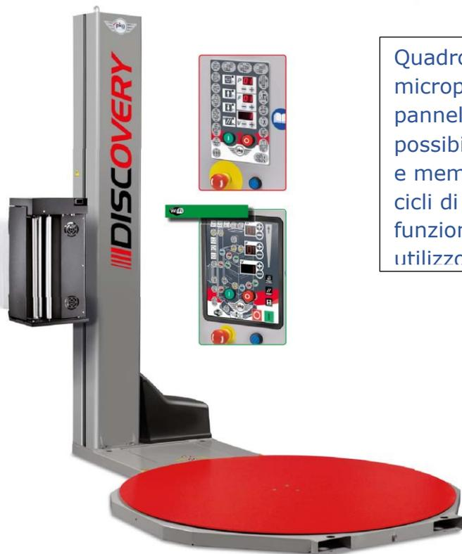
Quadro comandi a microprocessore con pannello digitale con possibilità di programmare e memorizzare fino a 99 cicli di avvolgimento, in funzione delle esigenze di utilizzo
